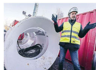
Jörgen Bergqvist vid styrutrusningen, som ska användas när röret trycks fram genom marken.
